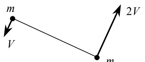
27. Две небольшие шайбы, массы которых равны  $m$  и  $m/2$ , связаны между собой нитью длины  $l$  и движутся по гладкой горизонтальной плоскости. В некоторый момент скорость шайбы массы  $m/2$  равна нулю, а другой –  $V$ , причем вектор  $\vec{V}$  перпендикулярен нити (рис.). Найдите силу  $T$  натяжения нити в процессе движения.
