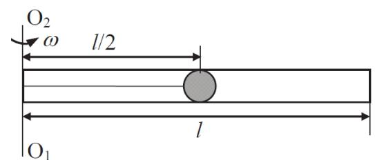
цу трубы и останавливается в результате абсолютно неупругого удара о торец трубы. Момент инерции трубы относительно оси  $O_1O_2$  равен  $I$ , шарик до пережигания нити находился на расстоянии  $l/2$  от оси вращения. Определите угловую скорость вращения трубы  $\omega'$  после удара, а также изменение кинетической энергии  $\Delta E$  системы «трубка – шарик». При решении задачи шарик считать материальной точкой.
